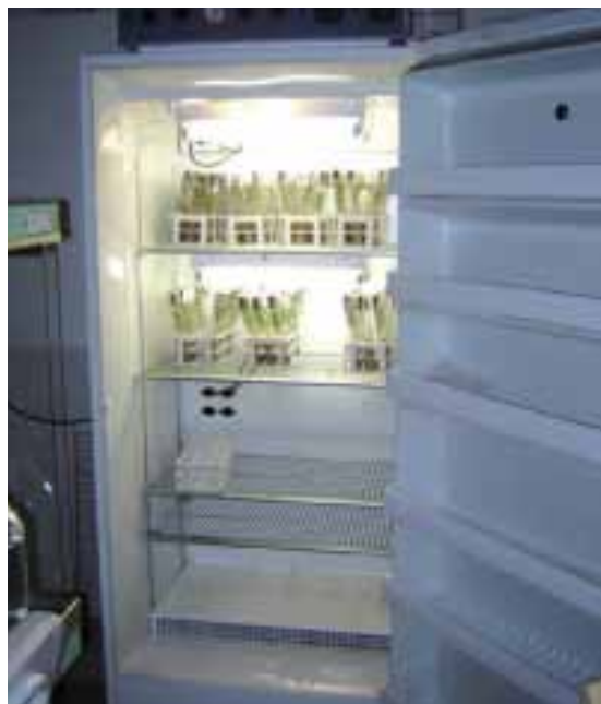
Foto 15: Cámara de germinación con temperatura controlada.
