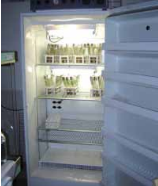
Foto 15: Cámara de germinación con temperatura controlada.
