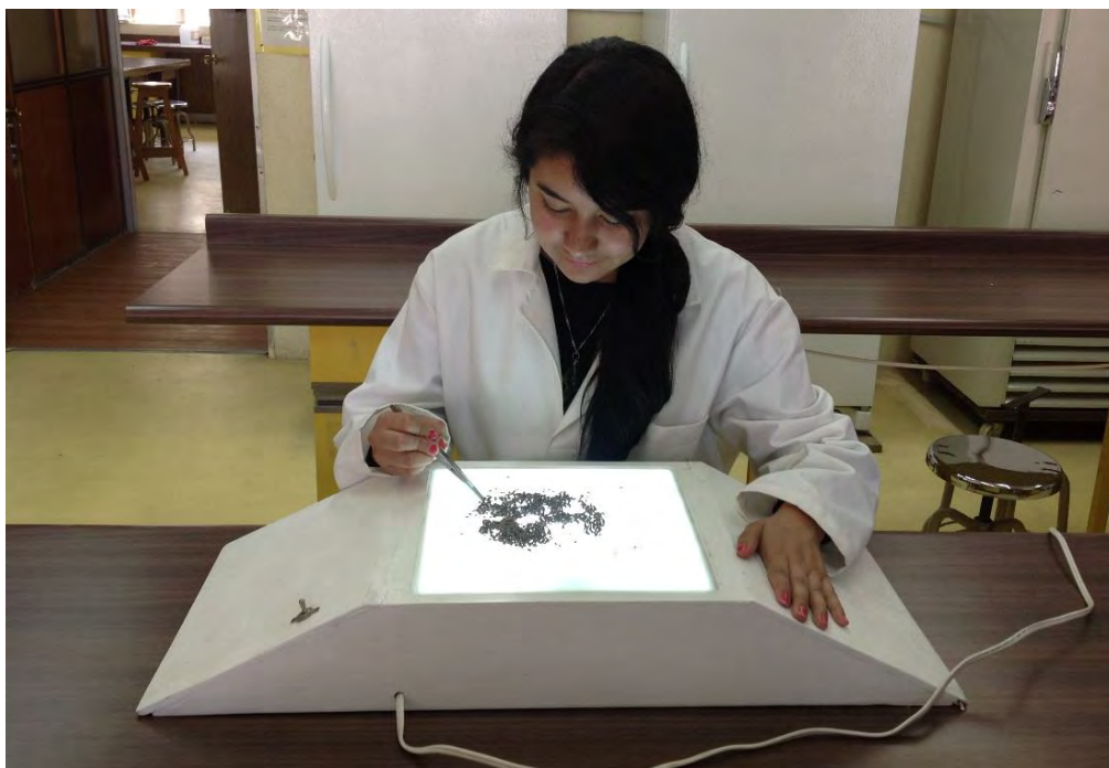
Figura 60.2. Mesa hechiza para limpiar la semilla. Cuenta con un foco interior que proyecta luz sobre la superficie translúcida de la base. Foto: DART, Laboratorio de Semillas Forestales, DICIFO, 2016.
