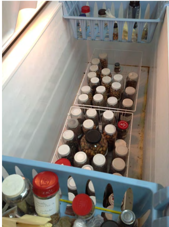
Figura 60.13. Frigorífico para dar tratamientos de estratificación y para almacenar semillas a pequeña escala, con fines de investigación. Laboratorio Semillas Forestales, Dicifo, UACH. Foto: DART, 2016.
