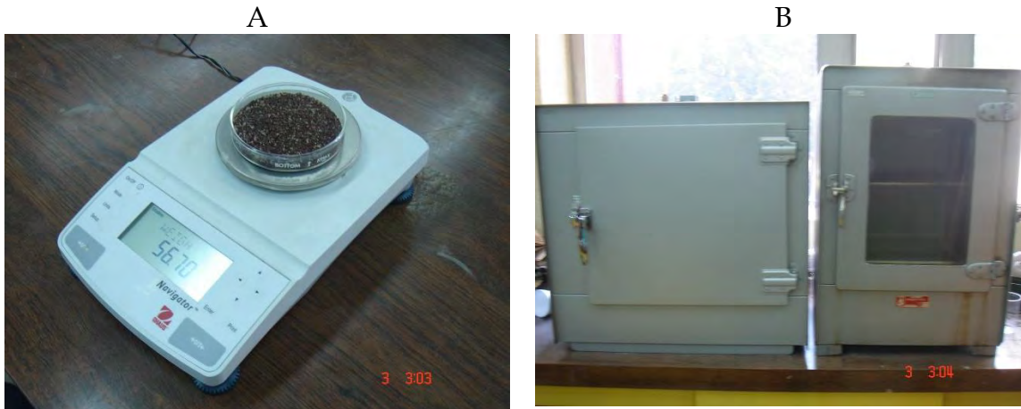
Figura 60.6. A) pesaje y B) secado en hornos para la determinación de contenido de humedad. Laboratorio de Semillas Forestales de la DICIFO. Foto: DART, 2016.
