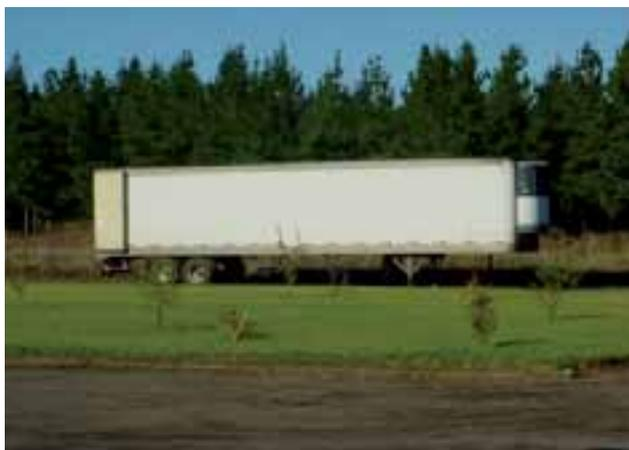
Figura 4. Carrocería refrigerada para almacenaje y transporte en frío de plantas.
