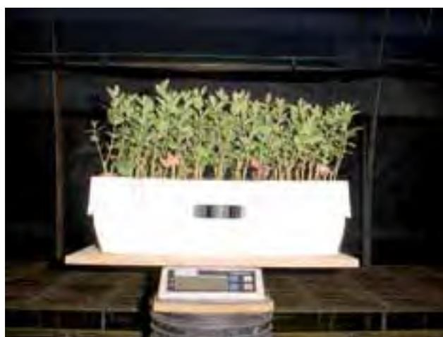
Figura 4. Balanza de plataforma para la determinación del contenido de humedad de las plantas cultivadas en bandejas.
