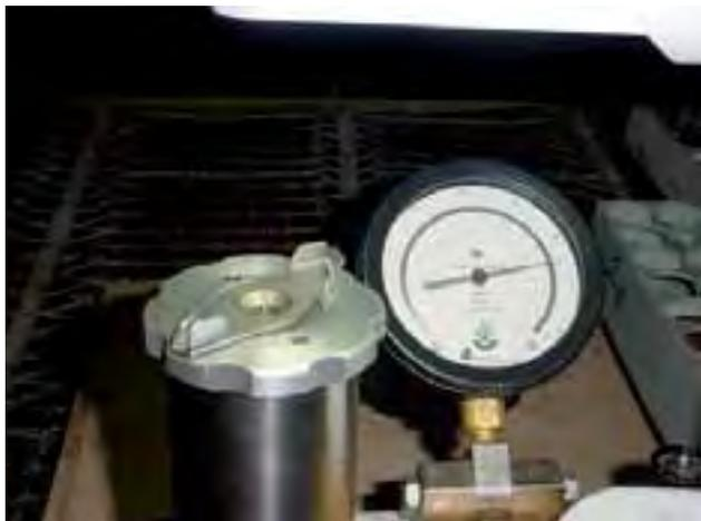
Figura 3. Porción de tallo en la cámara Schölander para determinación del potencial hídrico de la planta.
