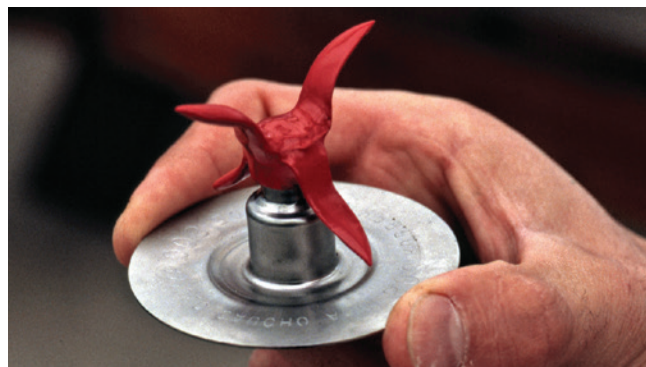
Figura 8.17 —La modificación de las cuchillas de una licuadora de cocina usando un revestimiento de goma le permite al cultivador limpiar pequeños lotes de frutos secos y carnosos sin dañar las semillas. Foto de R. Kasten Dumroese.
