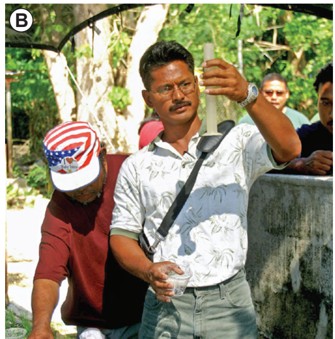
Figura 11.16 —Las comprobaciones periódicas de la distribución del agua pueden realizarse fácilmente con una “prueba de vasos” en la que se les dispone en cuadrícula (A). La profundidad del agua en los vasos se mide después de un período de riego estándar (B). Foto A de Kim M. Wilkinson, y foto B de Thomas D. Landis.
