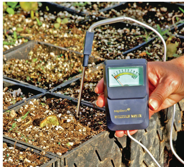
Figura 11.14 —Se pueden utilizar muchos tipos de herramientas para ayudar a comprobar y evaluar la eficacia de la aplicación de agua, incluido este higrómetro. Sin embargo, las evaluaciones visuales y táctiles son más frecuentes en los viveros de plantas tropicales y pueden ser muy eficaces cuando las realiza personal capacitado. Foto de Thomas D. Landis.
