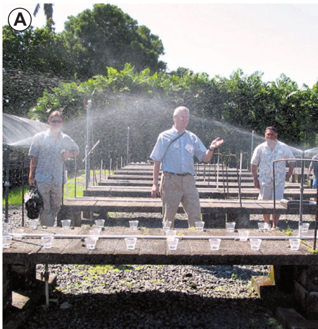
Figura 11.16 —Las comprobaciones periódicas de la distribución del agua pueden realizarse fácilmente con una “prueba de vasos” en la que se les dispone en cuadrícula (A). La profundidad del agua en los vasos se mide después de un período de riego estándar (B). Foto A de Kim M. Wilkinson, y foto B de Thomas D. Landis.
