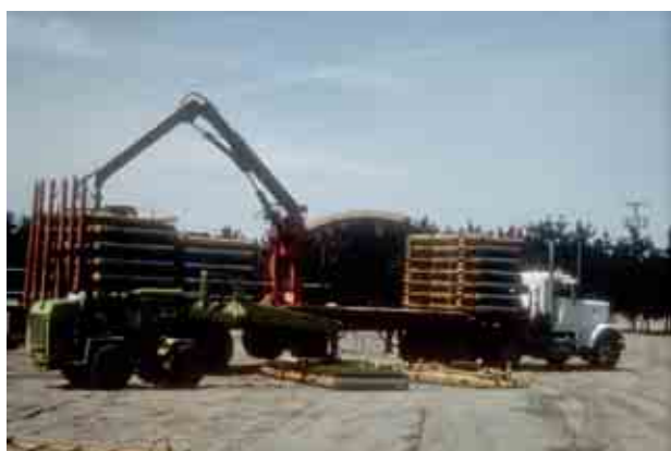
Figura 1.4.16 Los sistemas de manejo de contenedores mueven plantas del área de propagación al área de endurecimiento (A) y de ahí a los sitios de plantación (B) y algunos son sumamente sofisticados.
